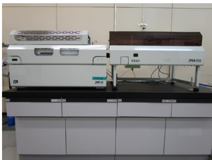
【図 1】炭素・水素・窒素分析装置(ジェイ・サイエンス社製 MICRO CORDER JM10)
