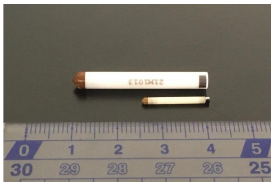
【図 2】 固体 NMR 試料管 (Varian 社製、上:4mm 管、下:1.6mm 管)
