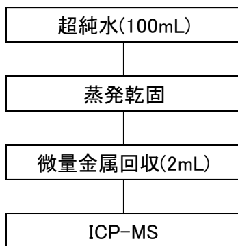
【図 1】 超純水中の微量金属分析フロー
